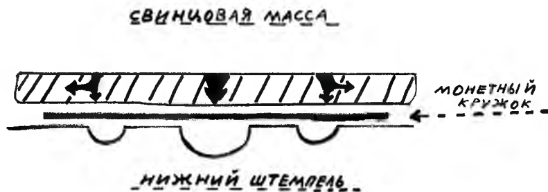
Рис. 1. Схема чеканки брактеата
